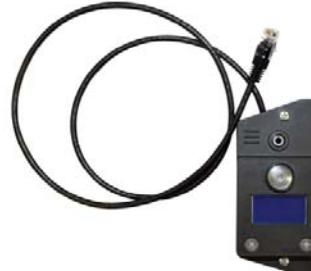
**Дисплей ТЕН: интерфейс должен быть использован персоналом, выполняющим обслуживание, для обнаружения неисправностей горелки.**
