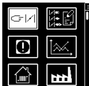
Se muestra la vista de conjunto de los menús y el menú de ajuste de las posiciones de la válvula de aire está seleccionado.
