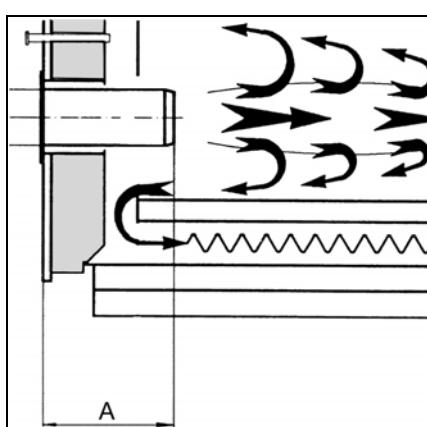
Для котлов с глухой камерой сгорания при выборе минимальной глубины А сопла горелки необходимо руководствоваться указаниями производителя котла.
