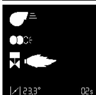
Блок управления ожидает разрешения на регулирование.
