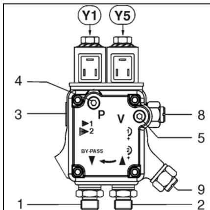
Насос шестрнчатого типа, самовсасывающий. Он должен присоединяться к двум трубопроводам через фильтр для удаления газов. Для соединения между топливной цистерной и фильтром для удаления газов предпочтителен однотрубный вариант. В насосе имеется входной фильтр и два регулятора давления топлива. Перед пуском в работу установите манометр для измерения давления 4 и разрежения 5.
