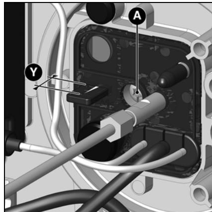
**El ajuste del aire en el cabezal de combustión** además del caudal de aire, influye también en la zona de mezcla y la presión de aire en el tubo del quemador. Giro del tornillo de ajuste **A**
