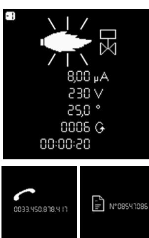
С помощью клавиш  $\nabla$  и  $\Delta$  можно вызвать информацию о 5 последних появившихся неисправностях (номер неисправности отображается в левом верхнем углу дисплея). После информации о 5 последних неисправностях появляется номер телефона службы послепродажного обслуживания, а также номер договора на техническое обслуживание (ни одно из значений не вводится на заводе).
