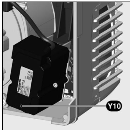
Регулировка подачи воздуха посредством воздушной заслонки Изменить подачу воздуха со стороны всасывания можно посредством изменения наклона воздушной заслонки. Воздушная заслонка приводится в действие серводвигателем Y10.
